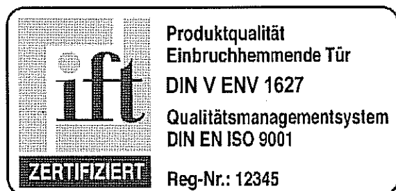
Bild 4 Kennzeichnungsschild für einbruchhemmende Türen nach DIN V ENV 1627
